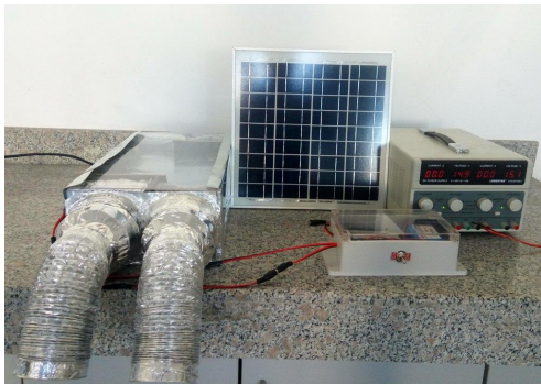
图 2 太阳能新风系统实体模型
