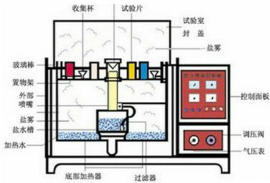
图3 盐雾试验机原理图
