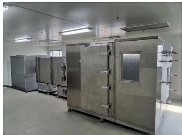
图 1 FFU 性能检测台
