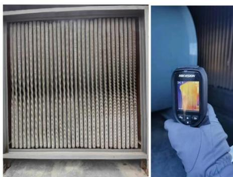
图 7 热管换热器实物图
