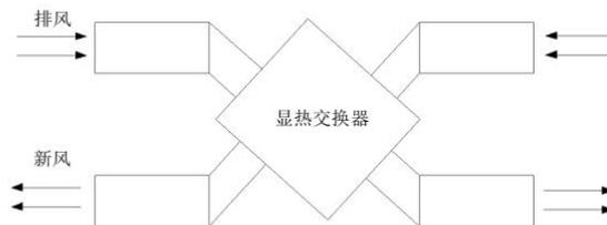
图 3 烘干排湿回热器热回收示意图
