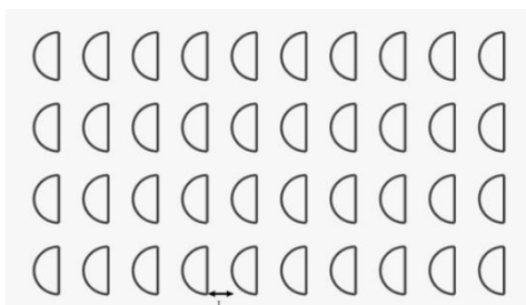
图 2 鱼鳞结构排布与单个鱼鳞结构尺寸模型图
