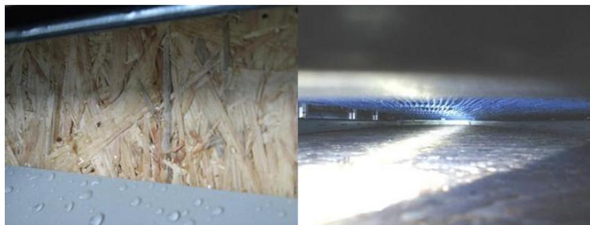
图 4 试验后柜壁上的凝水
