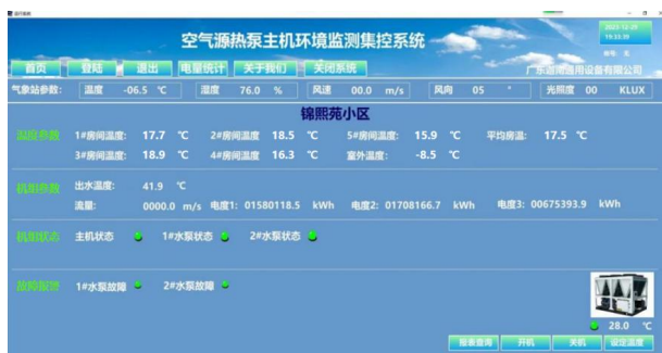
图 2 空气源热泵主机环境监测集控系统主界面
