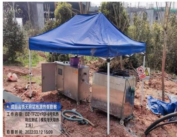
图 5 热响应试验现场图片
