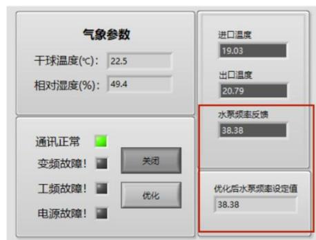
图 4 优化后水泵频率值和水泵频率反馈值对比
