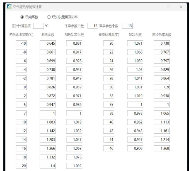
图 10 地源热泵多能耦合系统方案设计软件“空气源热泵能效计算”对话框
