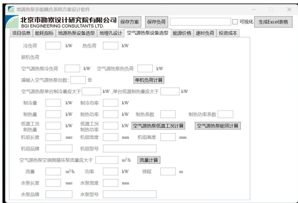
图 9 地源热泵多能耦合系统方案设计软件“空气源热泵设备选型”选项卡
